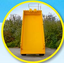
Mulde aus einer Bodenplatte und 2 einzelnen Seitenblechen aus 4 mm starkem HLE-Stahl
